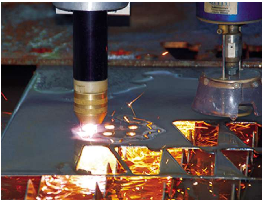
Bild 1: Die Schneidmaschine Waterjet Combo ist mit einem Plasmabrenner und einer Hochdruckwasserdüse ausgestattet. Sie kann zwischen den schneidenden Werkzeugen während der Programmdurchführung völlig automatisch umschalten.
